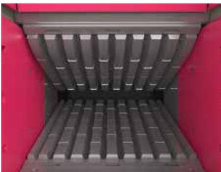
Die Konstruktion des Einschwingenbrechers mit dem 1905 mm tiefen Brechraum ist für Hartgestein und große Aufgabegrößen bestens geeignet. Die Einstellung des Brechspalts erfolgt mit hydraulisch betätigten Keilen.
